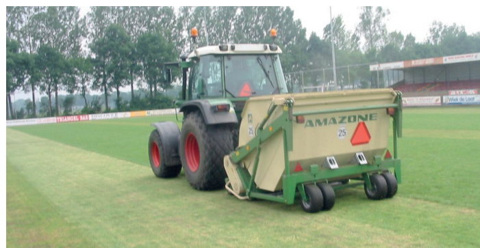
Figuur 1 Maai- en verticuteermachine (Amazone) zorgt voor een dikke grasmatt en lage schimmeldruk. Bron foto: www.bscn.nl
