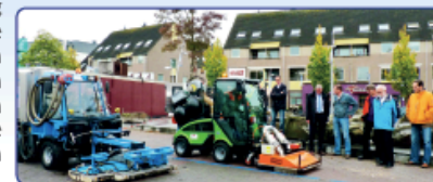
Foto 2: heetwater- en heetluchtmachine
