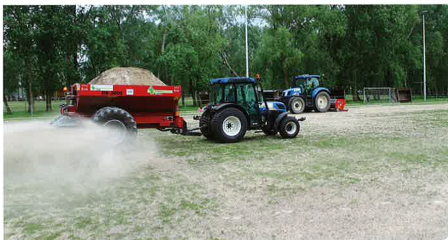
Voor het bezanden (verschralen) wordt gewassen rijnzand gebruikt.
