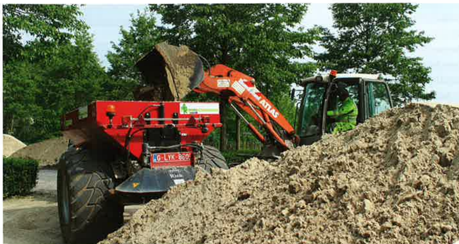
Voor het bezanden (verschralen) wordt gewassen rijnzand gebruikt.
