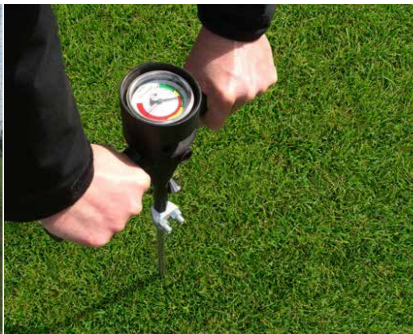
De verdichting van de bodem kan makkelijk gemeten worden door gebruik te maken van een penetrometer.
